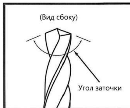
Рисунок 4: Угол заточки сверла
